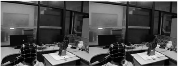
图9 脑电信号控制机器人(想象右手运动)
