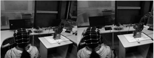
图8 脑电信号控制机器人(想象左手运动)
